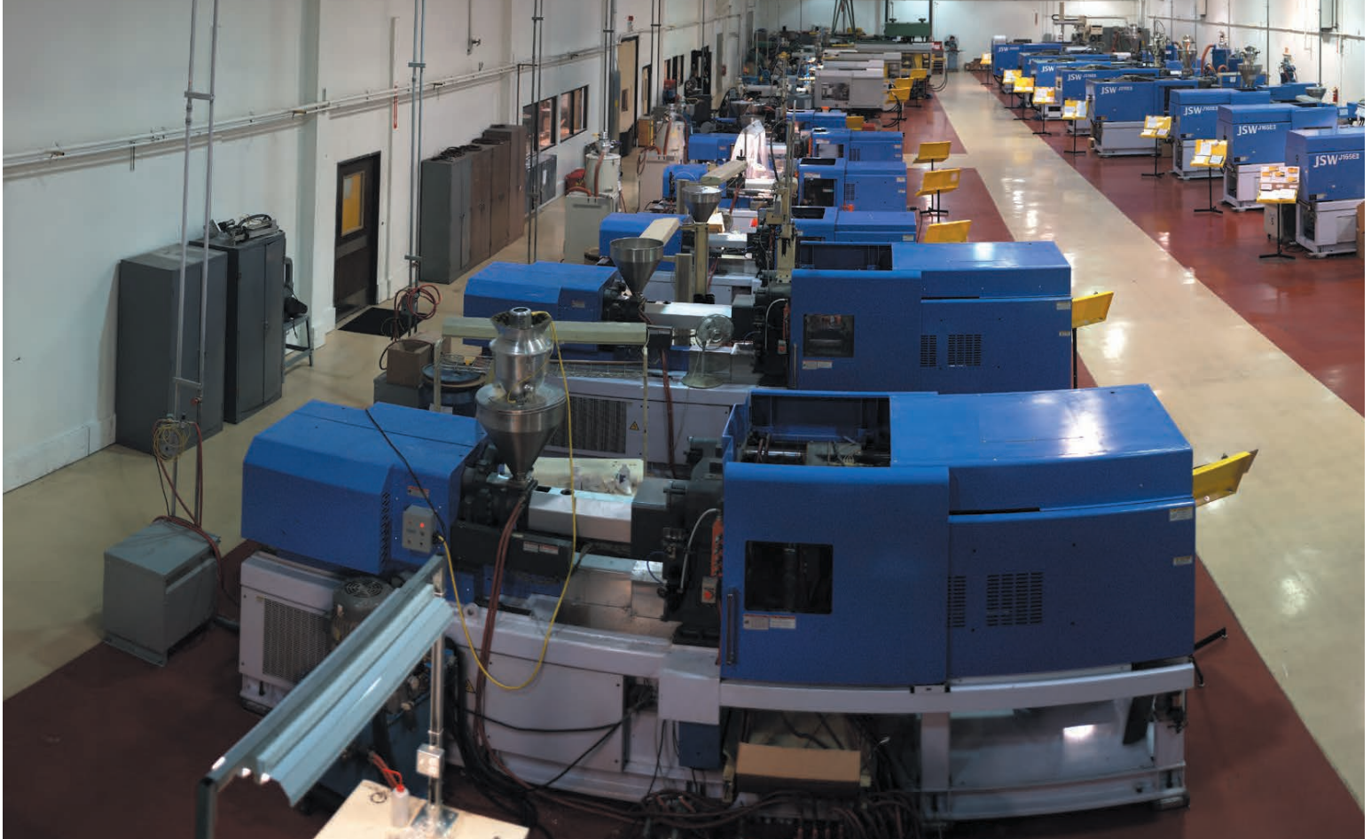
Vista de las máquinas de moldeo. Prensas de moldeo por inyección JSW: estabilidad y capacidad de repetición.
